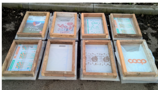
Obr. 1 Testovací rámy opatřeny biotaškami před vložením do kompostové zakládky (Foto autor 16. 2. 2016)
