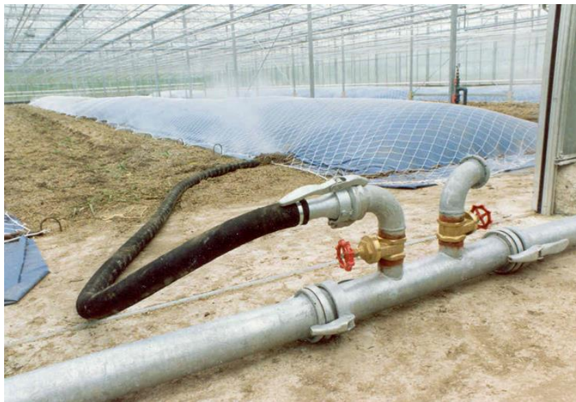
Obrázok 40 Tepelná dezinfekcia pôdy pod špeciálnou preparovacou fóliou ( http://www.benfried.com/en/greenhouse/plastic-films/steaming-foil/ )
