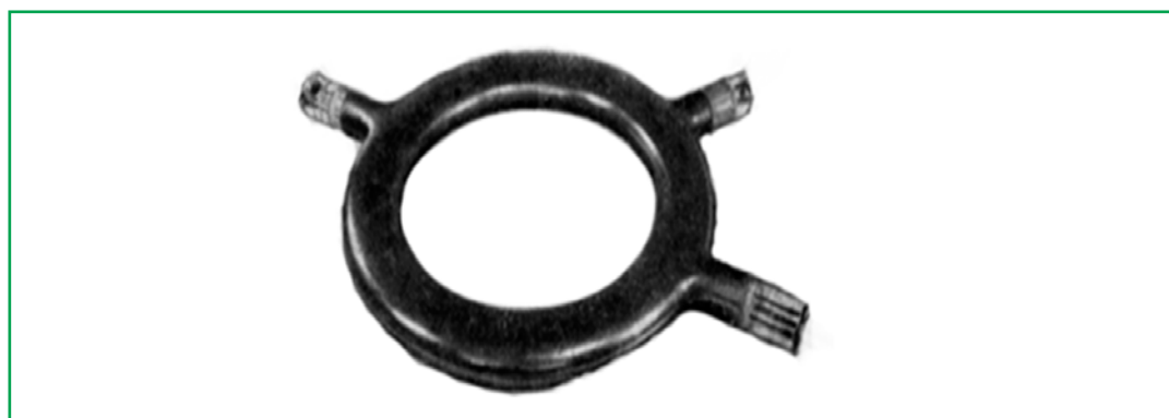
Рисунок 2 Відпаяна тороїдальна прискорювальна бетатронна камера РБК2-25Э
