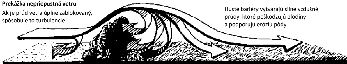
Obr. 1 Vplyv priepustnosti na prúdenie vzduchu okolo aerodynamickej bariéry (ICRAF, 1994)
